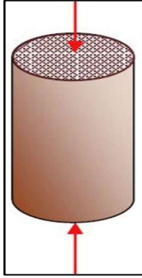
Tek eksenli sıkısmada kaya malzemesine uygulanan yük
